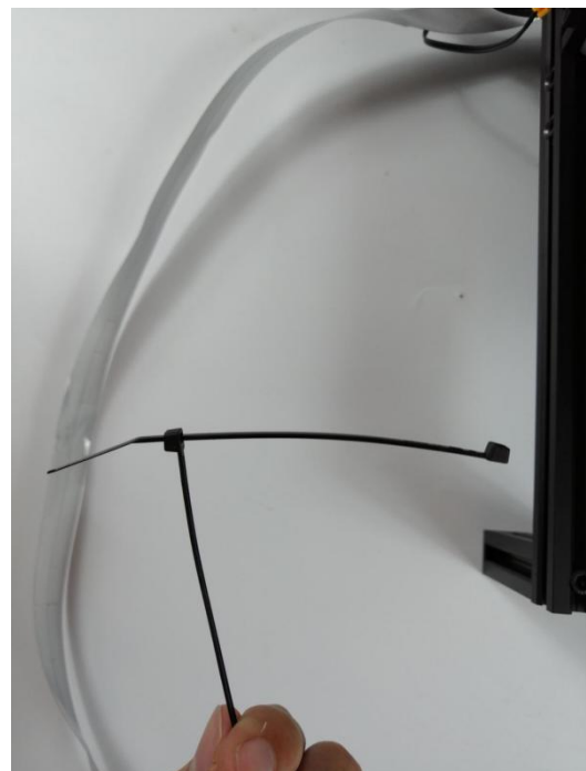
Le serre-câble ne peut pas être trop serré
