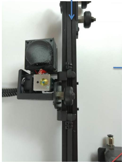
La tension de la courroie peut être ajustée par les deux vis de la boîte
